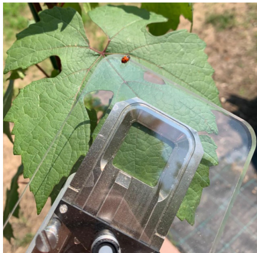
Figura 2. Misurazione dei parametri ecofisiologici in piante con lo strumento infra-red gas analyzer, in grado di determinare il livello di scambio di acqua, anidride carbonica e ossigeno con l'ambiente.
