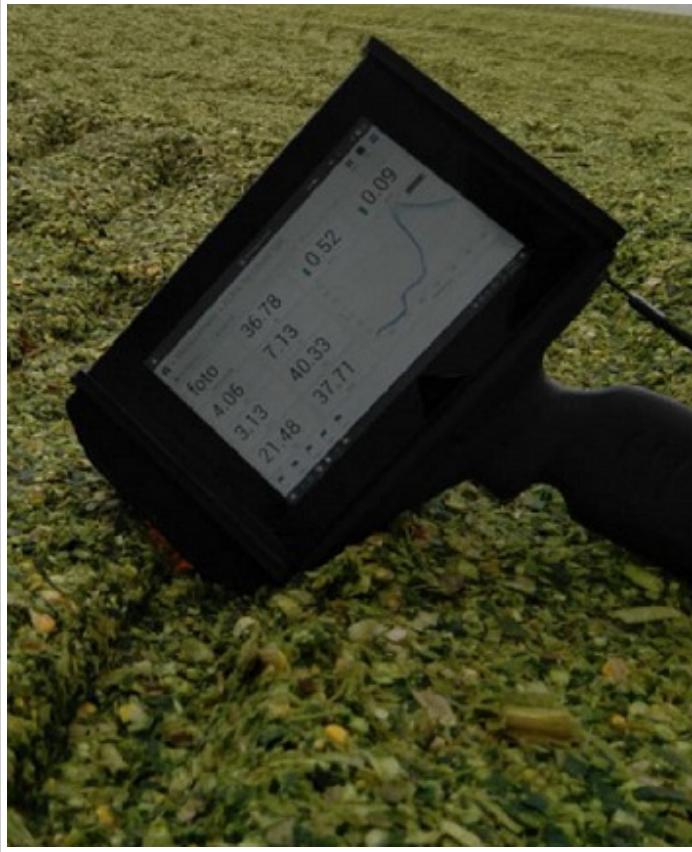
Fig. 1. Spettrometro NIR al lavoro
