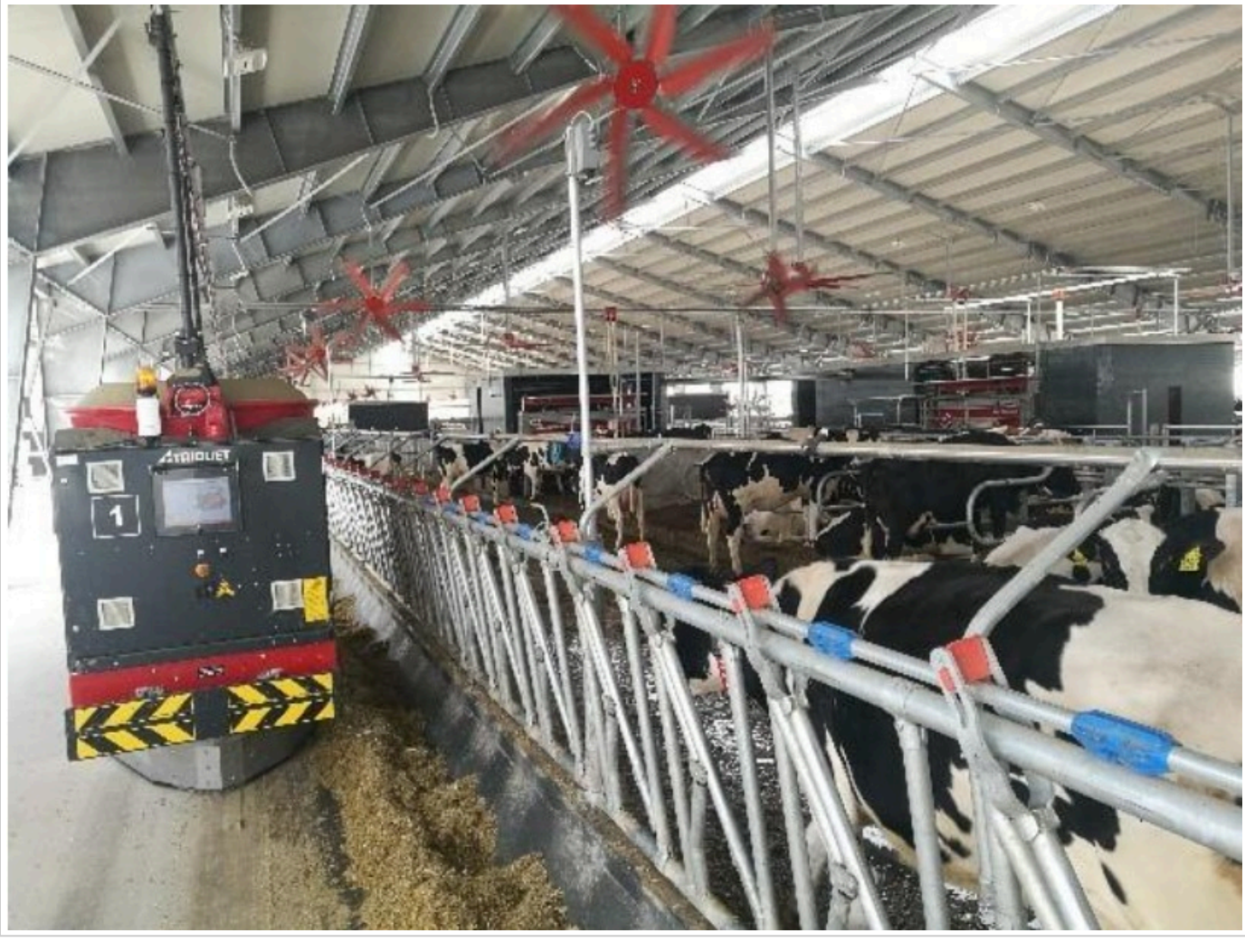
Fig. 1 – Esempi di robot per la preparazione e distribuzione ad elevata frequenza di razioni unifeed in allevamenti bovini (Foto degli autori)
