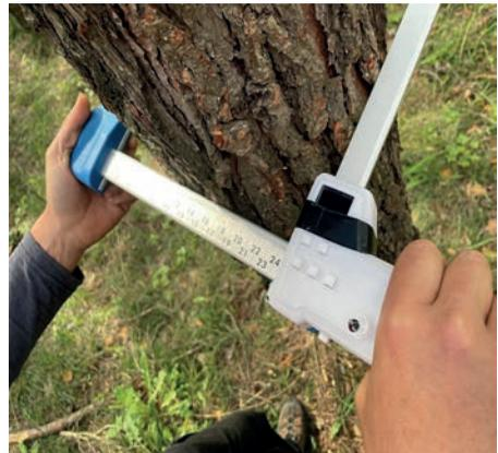
Il laser si trova sul retro dell’impugnatura del cavalletto. Misurando il tempo che impiega la luce a percorrere l’andata e ritorno tra il blocco bianco e quello blu, nota la velocità della luce laser, si ricava la distanza percorsa e, dividendo per due, il diametro della pianta
