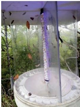
Figura 3 – Trappola a fluorescenza per campionamento lepidotteri.
