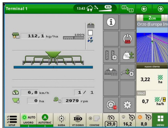
Figura 5 – Monitoraggio in tempo reale delle caratteristiche di distribuzione durante una semina.
