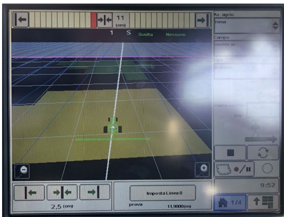
Figura 2 – Monitor per la gestione della distribuzione sito-specifica. La trattrice con la barra irroratrice attraversa una zona da trattare.
