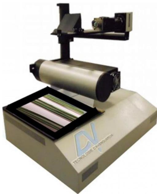
Fig. 7 – Camera iper-spettrale
