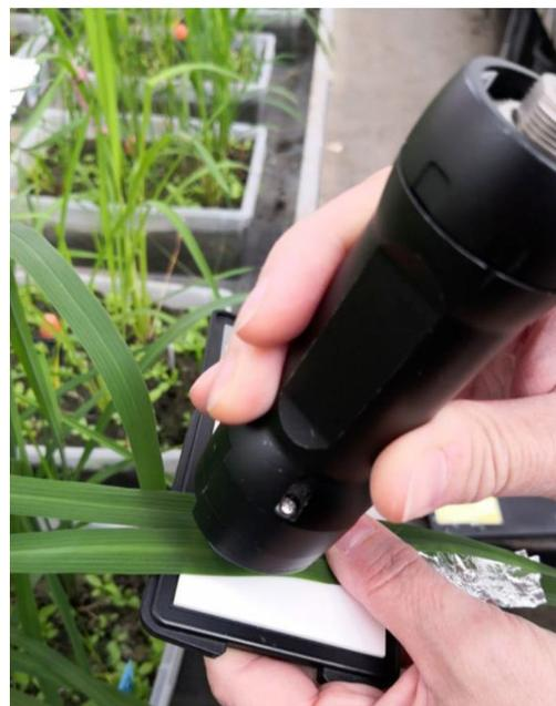
Le prove in serra hanno dimostrato che la spettroscopia NIR portatile può essere impiegata come misura rapida e non distruttiva per la previsione simultanea di più parametri relativi allo stato fisiologico delle piante di riso. Entrambe le tecnologie non distruttive impiegate hanno mostrato che l'applicazione dei fanghi di depurazione non ha influito negativamente sullo stato fisiologico delle piante di riso, risultati confermati dalle prove di campo.
