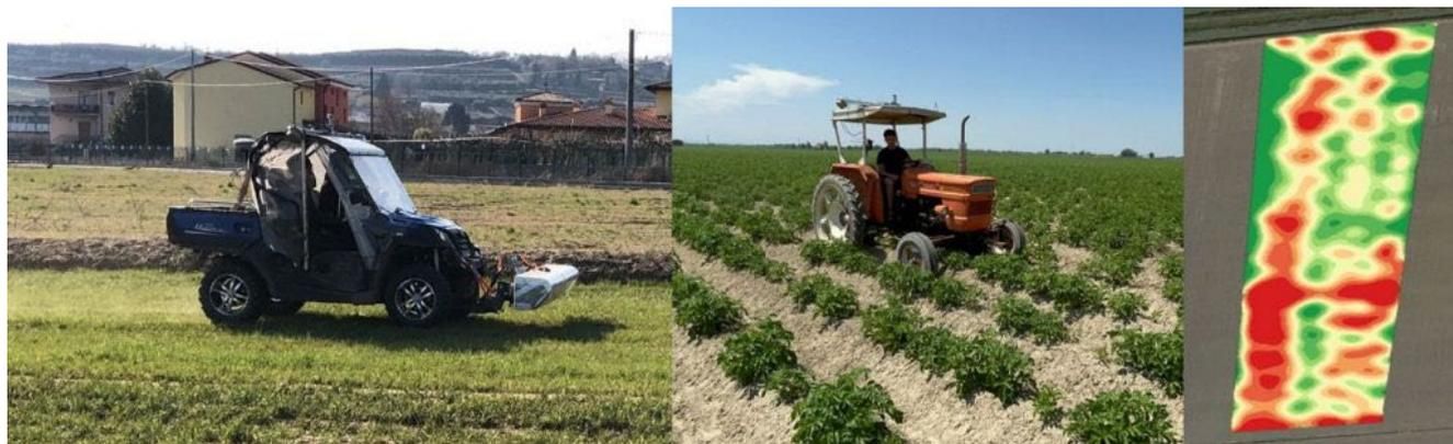
**Figura 2.** Sensore geoelettrico e sensore innovativo per il rilievo della conducibilità elettrica apparente del terreno e della vigoria della coltura sia su colture estensive che su colture a filare come frutteti e vigneti. I dati raccolti sono poi elaborati per ottenere mappe digitali georeferenziate. (Fonte: Speciale AGROENER. A cura di Francesca Antonucci. Terra e Vita, Supplemento al n. 36 – 30 Novembre 2022 – ANNO LXIII. ISSN 2421-356X).
