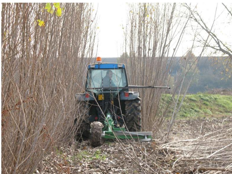
Sistema di raccolta continuo ad alta meccanizzazione basato sull'impiego di una falcia-trincia-caricatrice che in un solo passaggio effettua il taglio, la raccolta e la cippatura delle piante (*Forage-based Harvesting System* – FBHS) **(Foto 3)**.
