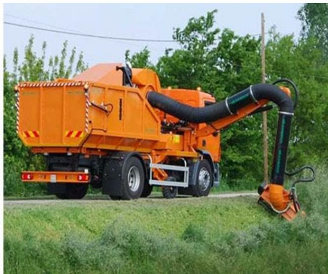
**Foto 7** – Tecnologie per lo sfalcio e raccolta della biomassa erbacea fluviale in un unico passaggio (camion e trattore con cassone dedicato) (fonte: [www.hymach.it](http://www.hymach.it))
