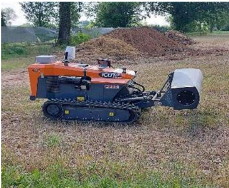
**Fig. 2** – Sensore geoelettrico montato a bordo del rover Ferri a guida autonoma
