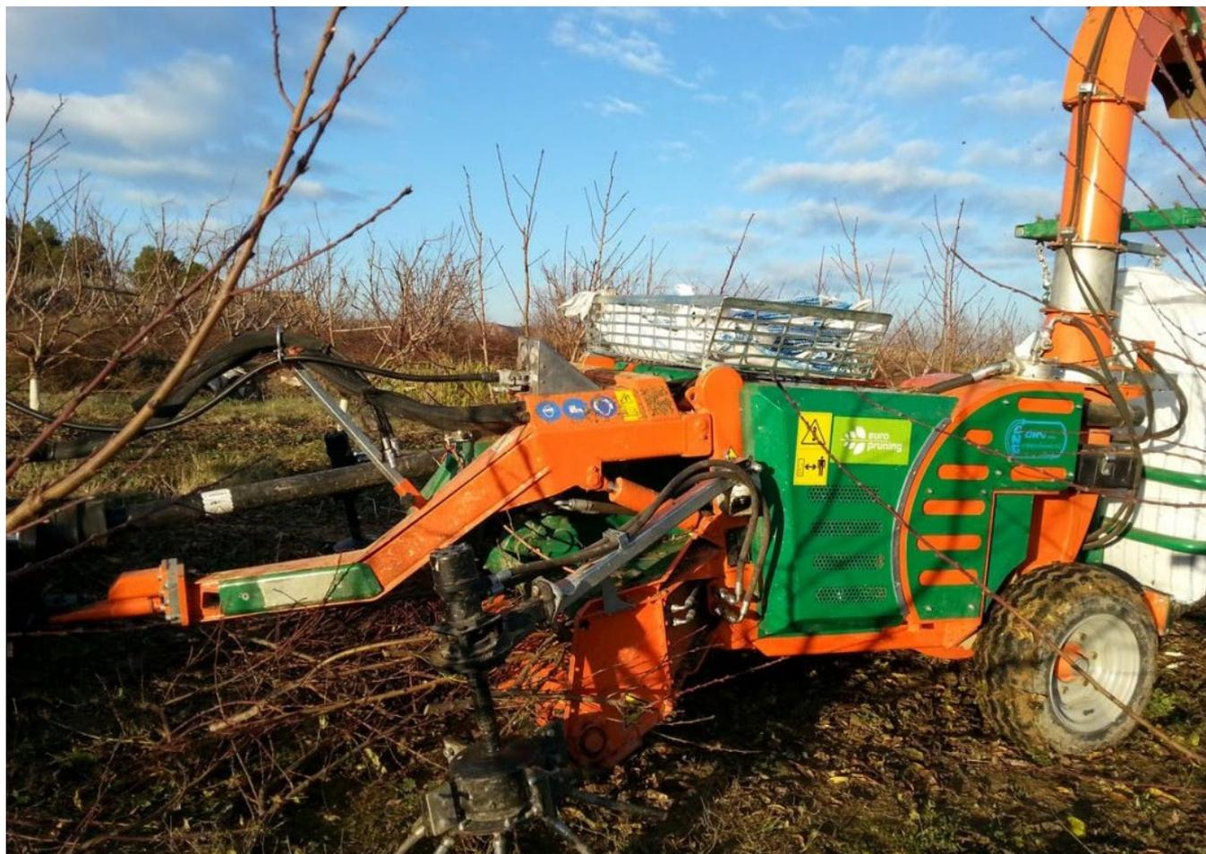
Figura 1. Prototipo PC50 per la raccolta delle potature sviluppato da ONG snc in collaborazione con il Centro di ricerca Ingegneria e Trasformazioni agroalimentari del CREA con il Progetto EUROPRUNING
