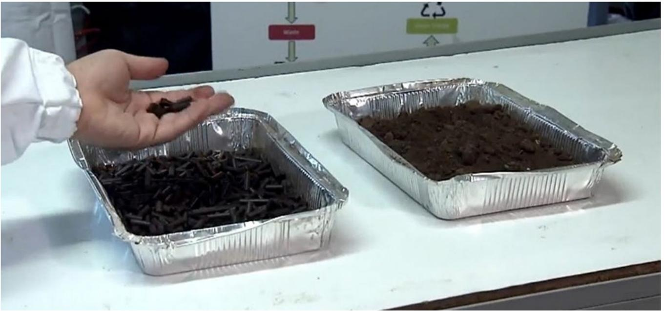
**Fig. 2** – *Nel vassoio di destra il residuo grezzo, in quello di sinistra il prodotto pellettizzato*
