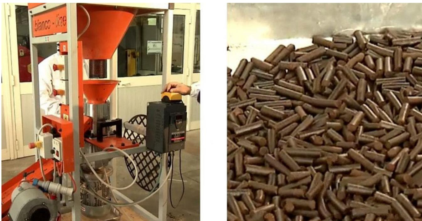
**Fig 1.** Processo di pellettizzazione dei fondi di caffè e segatura (sinistra); pellet ottenuto (destra)
