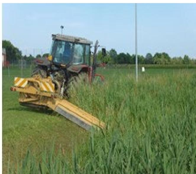
**Foto 4** – Linea di meccanizzazione per la gestione della biomassa spondale (braccio e trincia)
