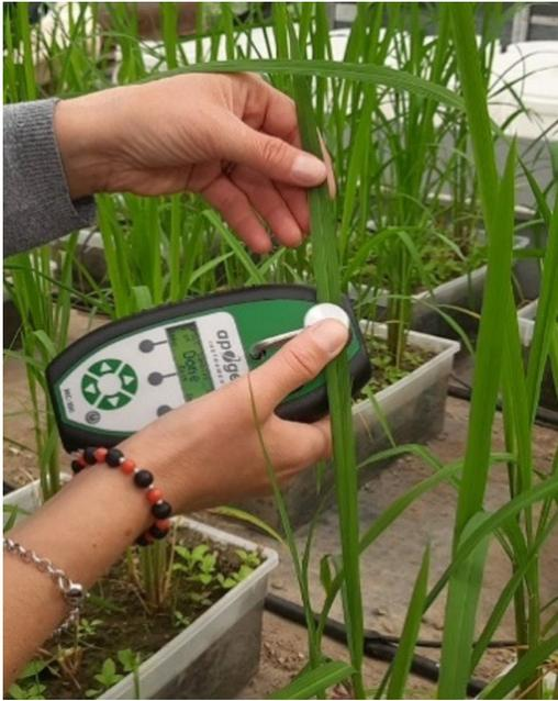
**Fig. 11** – Misure non distruttive di clorofilla fogliare (MC-100, Apogee, USA)
