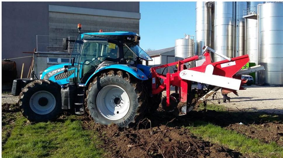
**Figura 3.** Sradicatore Officine Gottardo S.a.s. testato durante l'espianto di vite nell'ambito del Progetto SUSCACE
