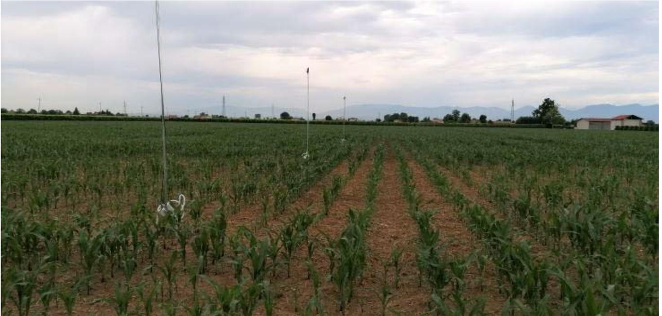
**Figura 3** – Campo sperimentale dotato di sistemi SWRS per catturare l'acqua. Il campo è stato anche dotato un sistema di centraline wireless per il monitoraggio costante dell'andamento dell'umidità del terreno a tre diverse profondità
