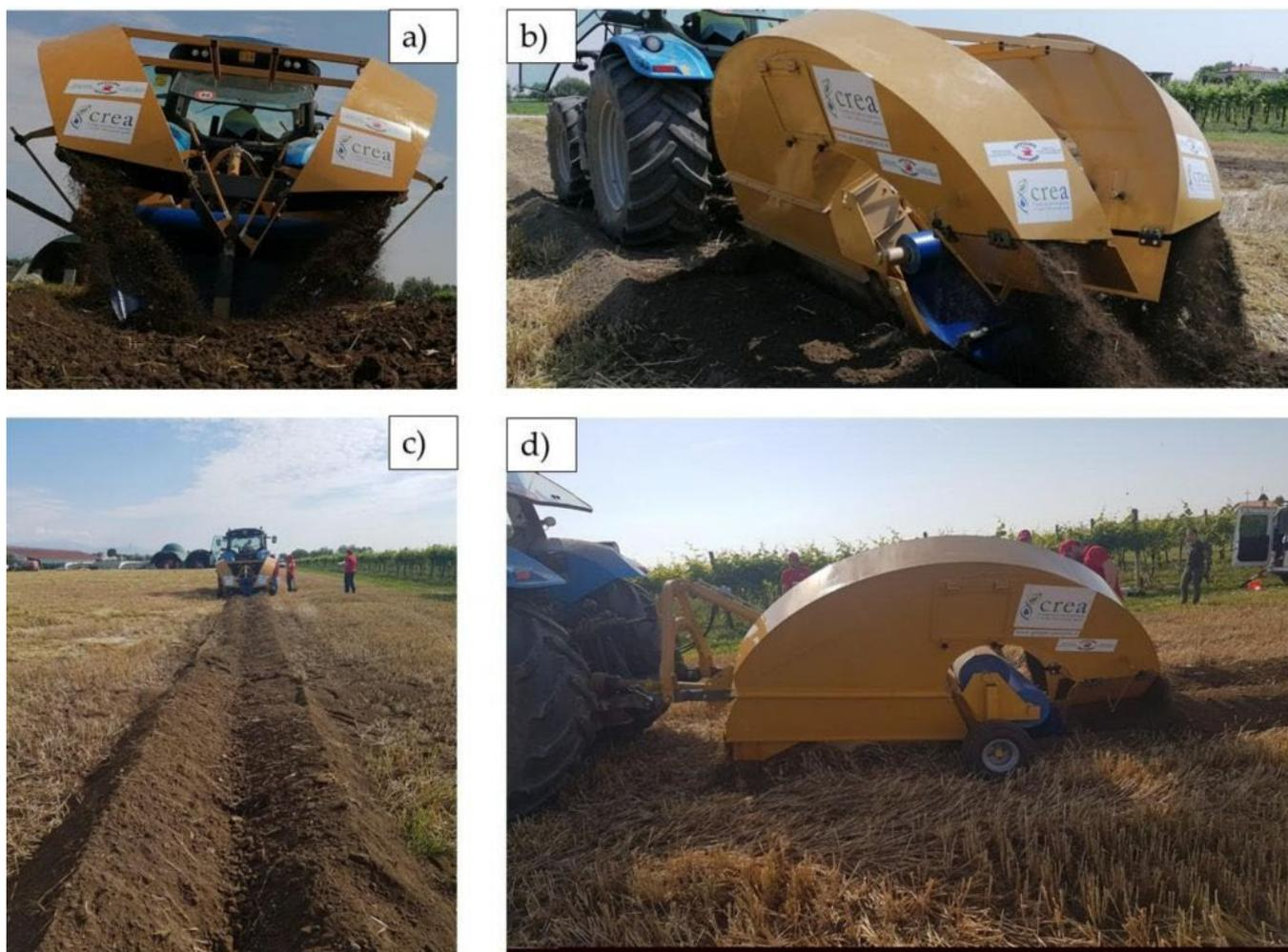
**Figura 2.** – Prototipo realizzato dal CREA Ingegneria e Trasformazioni Agroalimentari per la costituzione di bacini sotterranei SWRS, in fase di funzionamento in campo sperimentale in Veneto. Nei riquadri *a, b, c e d* si ha la vista del macchinario posteriore e di lato. Si può notare che, una volta installato il film impermeabile, il campo è pronto a ricevere le successive lavorazioni del terreno e la semina della nuova coltura.
