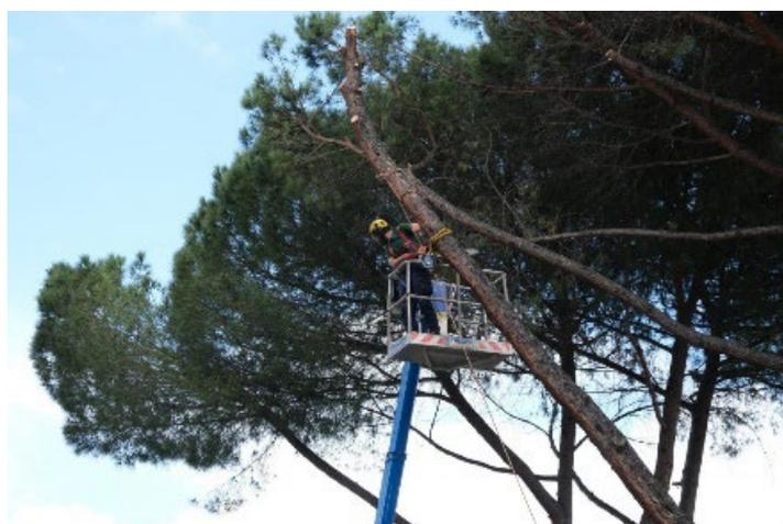
**Foto 1.** Fase di lavoro di un abbattimento controllato tramite PLE
