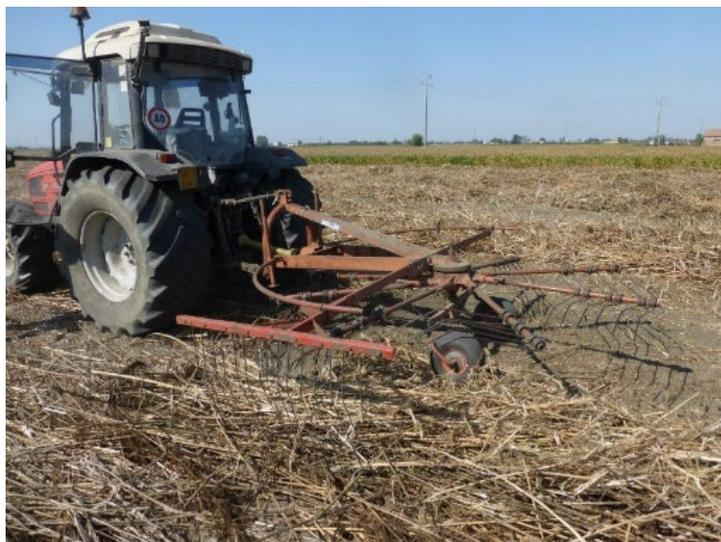
**Fig. 4 - Ranghinatore monogirante al lavoro su spessori importanti di biomassa. Foto di A. Assirelli, CREA- Ingegneria e Trasformazioni Agroalimentari**
